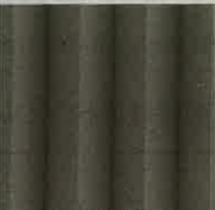
ホール加工 (V溝) P=25μm×h=24μm (さら小サイズも可)
