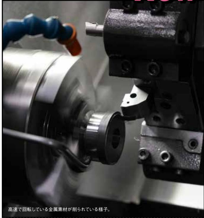
高速で回転している金属素材が削られている様子。
